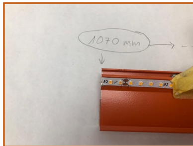
LED-Strip und Profil sind bündig
